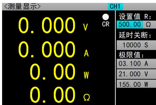
图 2.6.3 定电阻测量模式
