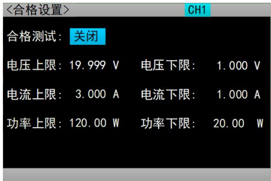
图 2.14.1 合格测试设置界面
