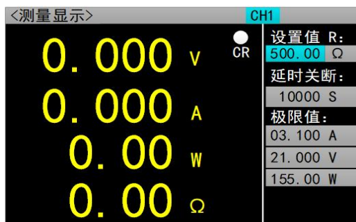
图 2.6.4 定功率测量模式
