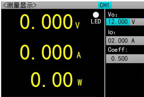
图 2.11 LED 测试界面
