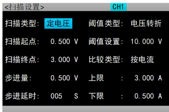
图 2.9.1 扫描测试设置界面
